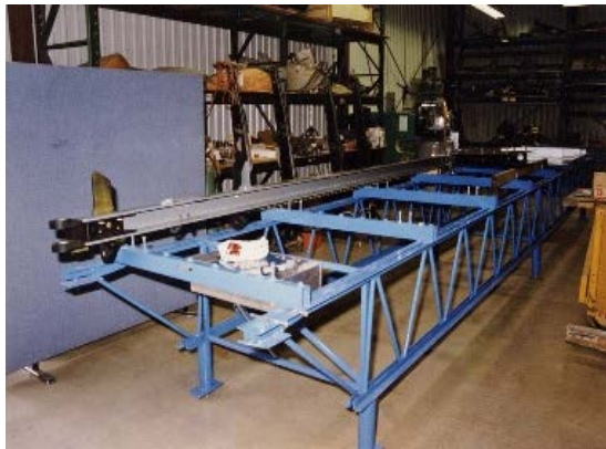
Halifax NA337 Main Spar jig
